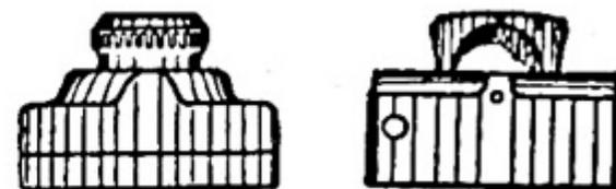
91. **Fil fusible:** élément calibré pour fondre sous une surcharge donnée et interrompre ainsi le circuit dont il fait partie.
